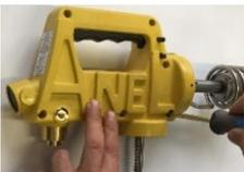
6. Retire la mitad superior del recubrimiento para que pueda verse el interior del vaporizador.
