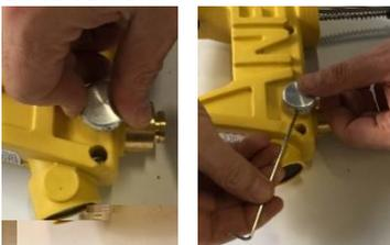
14. Coloque en su posición la parrilla de la resistencia, atornille los tornillos que la sostienen en su lugar y enrosque la boquilla pulverizadora.
