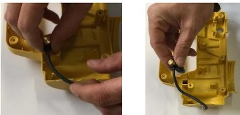
8. Retire la vieja bujía y sustitúyala por una nueva. Asegúrese de que el cable de alimentación eléctrica se encuentra en el lugar por donde pasa también el tubo en espiral de forma que al montar el aparato el extremo desnudo del cable de la bujía esté en contacto con el tubo en espiral.
