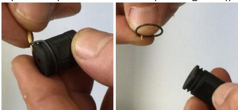
6. Coloque las nuevas arandelas como se muestra en la figura
