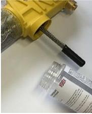
2. Agarre con una mano la parte inferior del sistema de bombeo (vaso) y con la otra el pistón que mueve el vaso (con el muelle) para separar el uno del otro.
