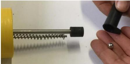
4. Desenrosque (hacia la izquierda) el pistón de bombeo. ATENCIÓN, en el interior se halla una bola, no la pierda (el sistema de bombeo funciona obligatoriamente con esta bola)
