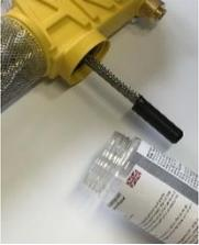
2. Retire los tornillos de soporte (2) de ambas partes del protector y después retire la boquilla pulverizadora del tubo en espiral.
