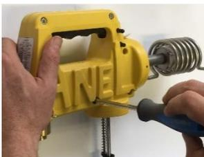
13. Ponga el regulador de flujo de gas en su lugar y atornille el tornillo lateral que lo sostiene sobre el eje de bronce de la válvula.
