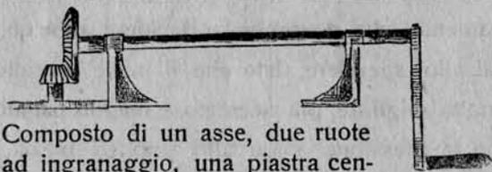
Composto di un asse, due ruote ad ingranaggio, una piastra centrale, due supporti e manovella
